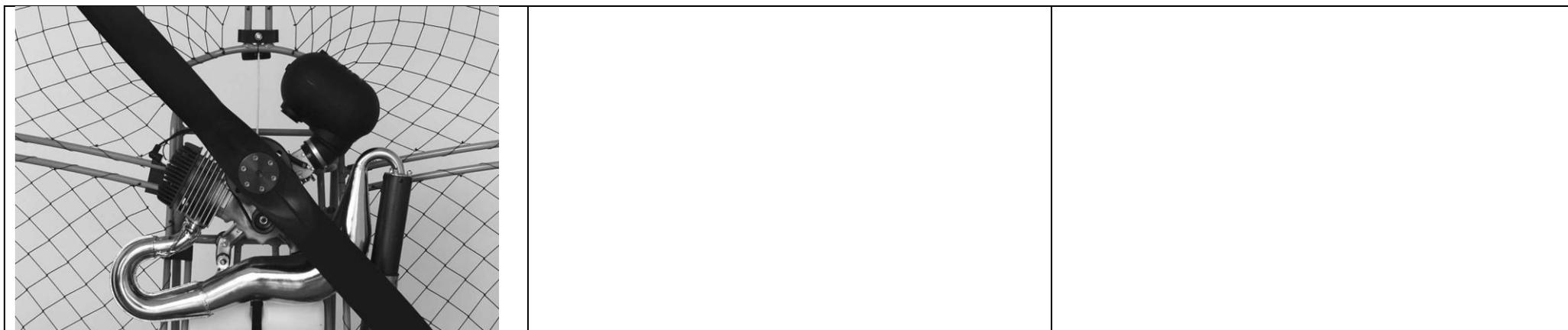
Modèle Moster185: hélice rotation vers la droite, compte tenu de la vue arrière (même point de vue l'image 4.1).
